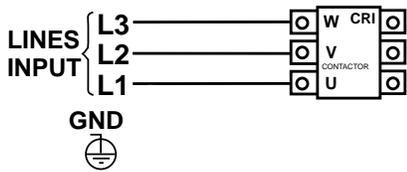
1. TURN OFF THE INPUT POWER USING THE DISCONNECT SWITCH AT THE FUSE BOX
