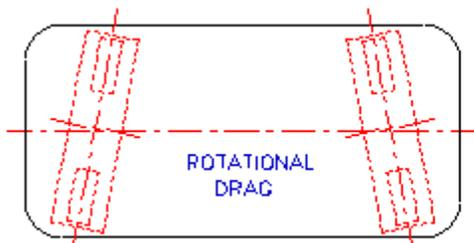
FIG. 3A - PIGEON-TOED CHASSIS DRAG
