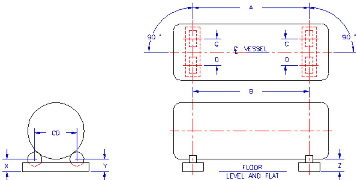
FIGURE 1 - PERFECT TURNING ROLL AND VESSEL ALIGNMENT
